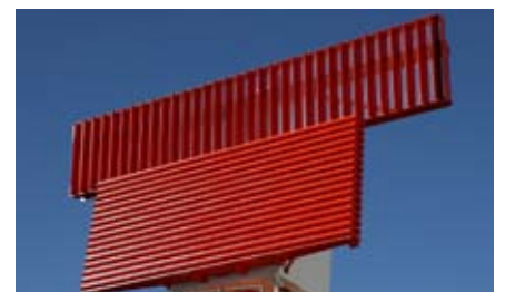
Antenas MSSR y Radar 3D
