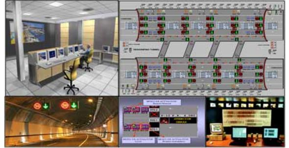
O produto Horus é um SCADA desenvolvido pela Indra, que permite a integração de diferentes equipamentos e sistemas para o controle e a monitorização de túneis. A aplicação apresenta um ambiente amigável e de fácil utilização para o operador, disponibilizando a maior informação possível no ecrã principal e notificando através de sinais visuais e sonoros, qualquer incidente que se apresente
