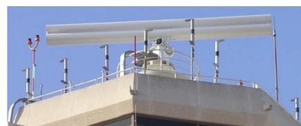
Antena del Radar de Superficie (SMR)
