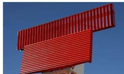
Antenas MSSR y Radar 3D
